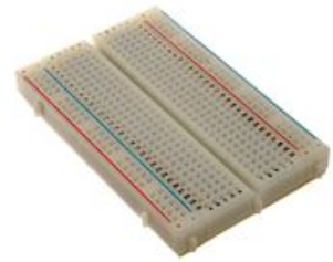
Slik ser et typisk breadboard ut
