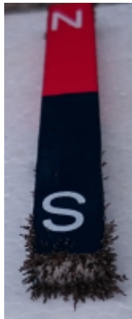
Figur 2: En magnet har trukket til seg jernfilspon.
