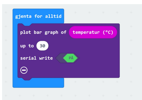
Fig. 3. Live logging av temperatur. Maks temperatur er satt til 30 og serial write er på sånn at man kan se temperaturen live på PCen
