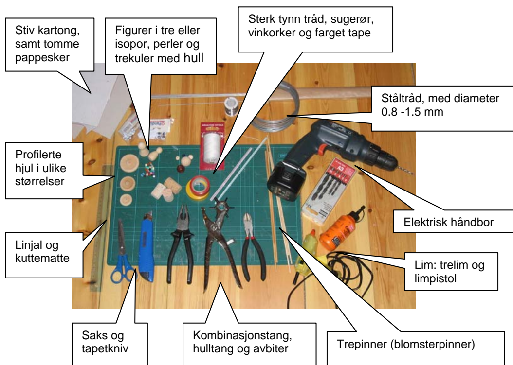
Figur 3. Utstyr og materiell for mekaniske leker
