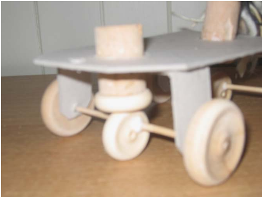
Figur 28. Montering av korken på det eksentriske hjulet
