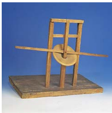
Figur 1. En av "bokstavene" i Polhems mekaniske alfabet. (Kilde: Tekniska Museet, Stockholm)
