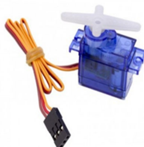
Robotene styres ved hjelp av to mikrokontrollere (micro:bit). Med mini-servoer kan vi gjøre bruk av rotasjonsbevegelse i roboten.
