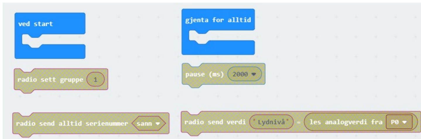
Figur 9: Blokker til kode for måling av lyd med VMA 309-sensor
