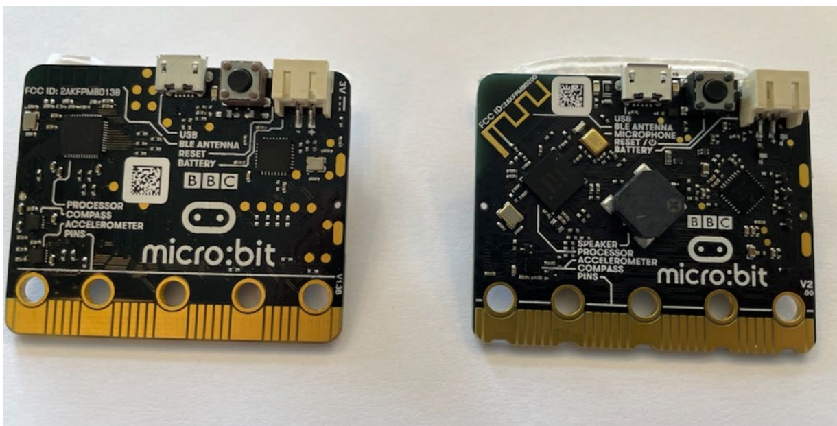
Micro:biten til venstre er den eldre versjonen, mens den til høyre er versjon 2.
