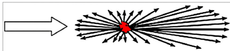
Figur 2.2 Mellomstore partikler (rundt 1 micron) slipper gjennom mer lys enn det som blir reflektert mot lyskilden.
