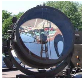
Innenfor brennpunktet blir bildet rettvendt og forstørret. Bildet ligger bak speilet
