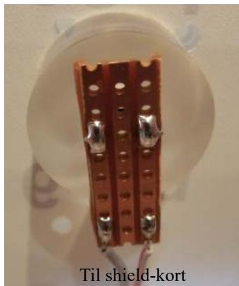
Hver LDR er montert på et lite kretskort som vist å figuren til venstre. Kortet sitter fast til sensorholderen ved at beina på LDR'en er loddet til kortet. Ved bytte av sensor løsnes holderen fra plata og beina loddes fra kortet. LDR'en kan så tas ut på framsiden av LDR-holderen.
