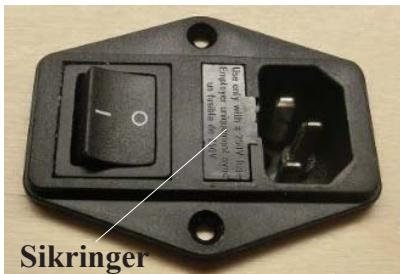
Modellen startes ved å sette stikkontakten i veggen og slå på hovedbryteren som er bak til høyre. Mellom bryteren og nett-tilkoblingen sitter sikringsholderen. Ved skifte av sikring vippes holderen ut med et skrujern og sikringene erstattes med *trege* 1 A sikringer (5 x 20 mm). Det er viktig at de er trege, da raske sikringer han ha problemer med å håndtere startstrømmene til strømforsyningen.
