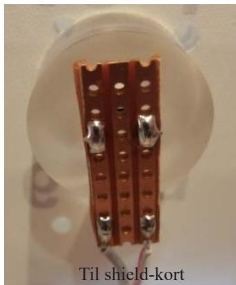
Hver LDR er montert på et lite kretskort som vist i figuren til venstre. Kortet sitter fast til sensorholderen ved at beina på LDR'en er loddet til kortet. Ved bytte av sensor løsnes holderen fra plata og beina loddes fra kortet. LDR'en kan så tas ut på framsiden av LDR-holderen.
