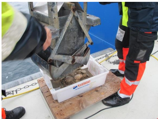
Bilde 7: Innhenting av sedimentsprøver med van Veen-grabb ombord på Gunnerus
