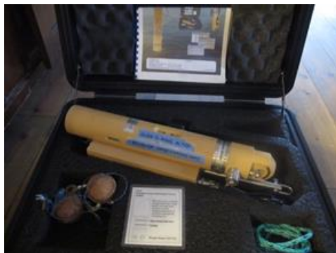
Bilde 6: CTD senkes ned med vannrosetten og måler ledningsevne, temperatur og dybde.
