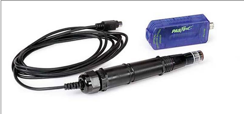
Bilde 26 Trådløs oppløst oksygen sensor PS-2196
