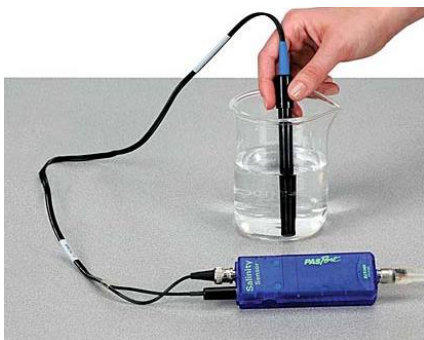
Bilde 27 Trådløs salinitet sensor PS-2195
