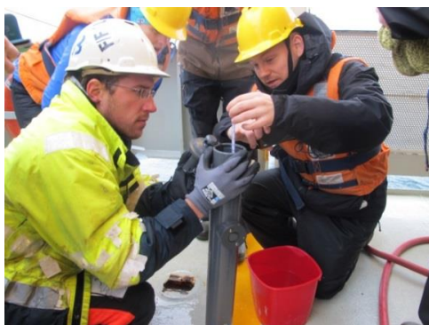
Bilde 5: Temperaturen leses av med termometer og densitet med hydrometer.
