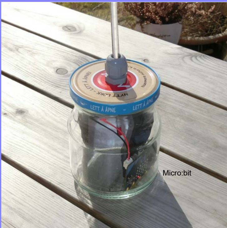
Trådløs logging av temperatur i "solfanger"
