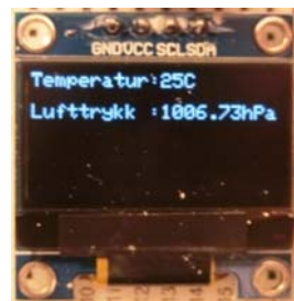
Figur 7.10 Temperatur og trykk vist på OLED-displayet.
