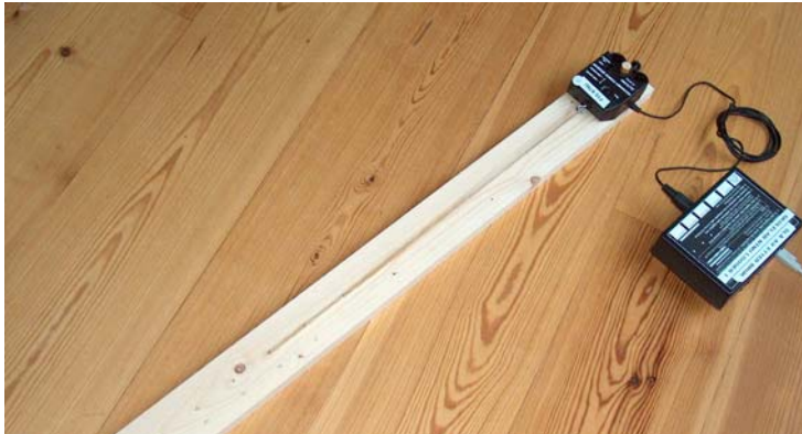
Figur 7 Måling av fjærkonstant ved hjelp av kraftsensor og datalogger.
