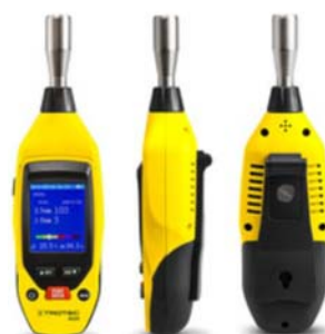
TroTec BQ20 måler luftfuktighet, temperatur og pm 2.5 og pm 10.0
