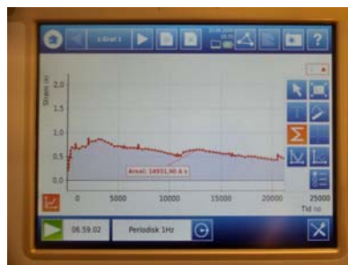
Figur 2.12 Ladningstransporten gjennom oppløsningen finner vi å beregne arealet under strømgrafene.
