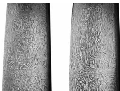
Figur 2.3 Strukturen i Damask stål
