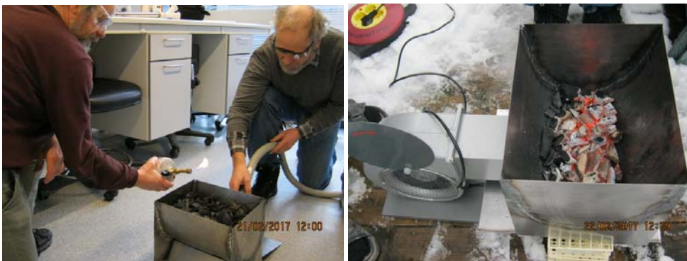
Figur 4.19 Opptenning med bruk av "støvblåser", en gassflamme brukes for å påvise trekken i ovnen (t.v.). Opptenning ved bruk av lab. vifte (t.h.). Foto: Hilde Ervik.
