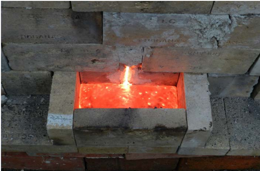
Figur 4.14 Tapping av tyntflytende slagg (Foto © Tore Haug-Warberg, 2013)
