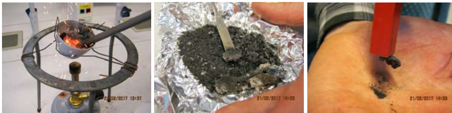
Figur 4.21 Resultatet etter manuell framstilling av framstilling av jern fra malm. Oppvarming (t.v.), en klump med finfordelt jern i magnetitt? (midten), påvist magnetitt (t.h.). Foto: Hilde Ervik
