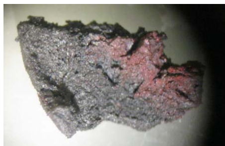
Figur 4.21 Resultatet etter manuell framstilling av framstilling av jern fra malm. Oppvarming (t.v.), en klump med finfordelt jern i magnetitt? (midten), påvist magnetitt (t.h.). Foto: Hilde Ervik
