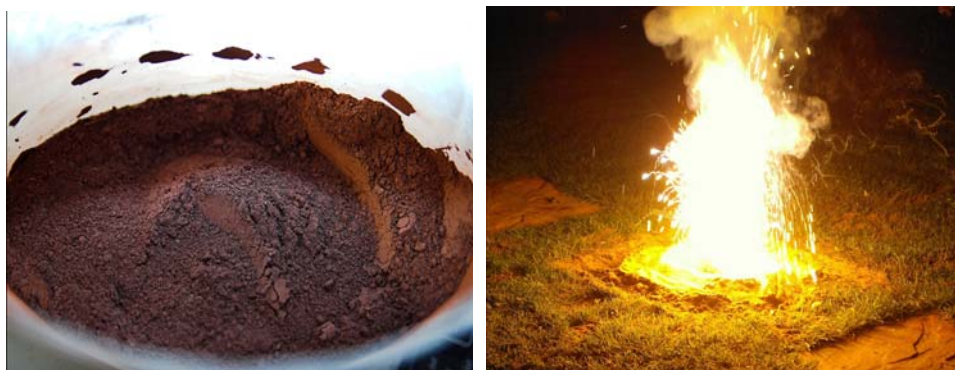
Figur 4.25 A) Blanding av jernoksid, B Termittreaksjon 8
