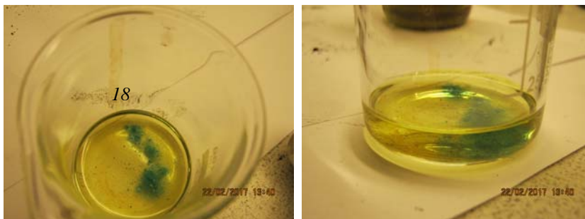
Figur 4.24 t.v påvisning av Fe^{2+} med rødt blodlutsalt, t.h. påvisning av Fe^{3+} med gult blodlutsalt.
