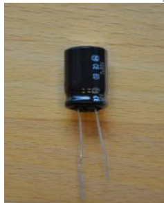
Figur 10.11 Kondensator 3300µF Det lange beinet er +
