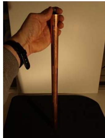
Figur 6.3 Magnet som faller i et kobberør med slisse.
