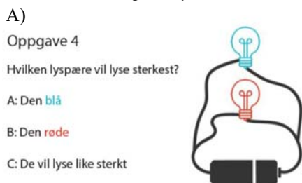
Figur 2.38 A) Oppgave 4 tester elevenes forståelse av parallellkobling. B) Resultatene synes å vise en betydelig tro på at den nærmeste pæra lyser sterkest.
