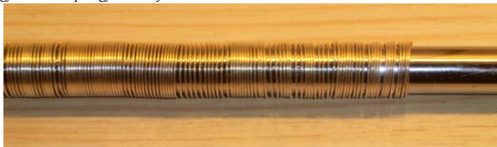
Figuren over viser enden av spolen viklet på et forkrommet stålrør.
