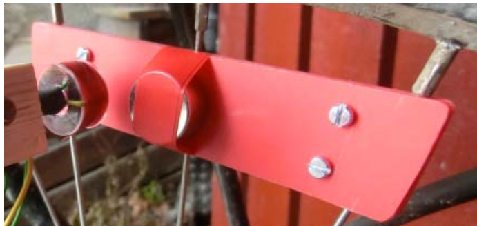
Figur 6.13 Montasje av neodymmagnet.
