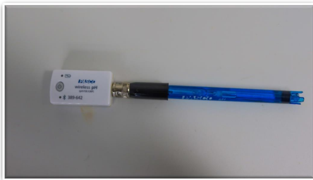
Figur 25: Trådløs pH sensor PS-3204
