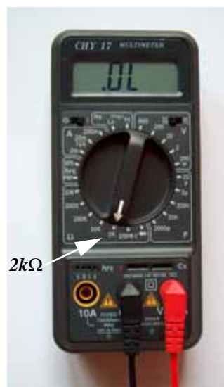
Figur 76 Måling av resistans
