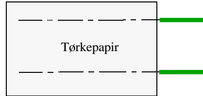
Figur 104 Ved å tre de avisolerte ledningene gjennom et tørkepapir økes detektorens følsomhet for små vannmengder.
