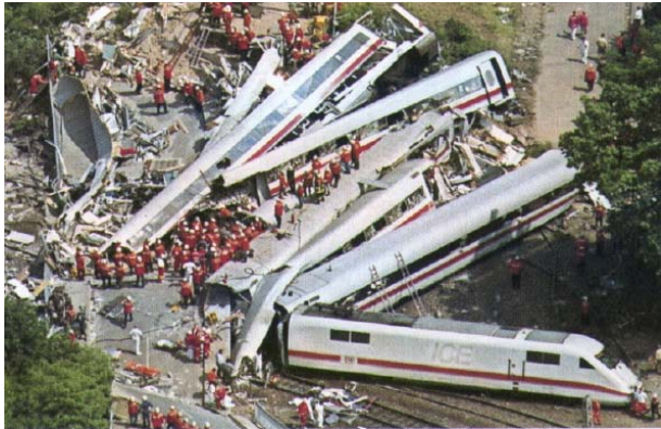
Avsporing av høyhastighetstog i Eschede, Tyskland, der 101 ble drept og 194 skadet. Årsaken var materialfeil i ett av hjulene
