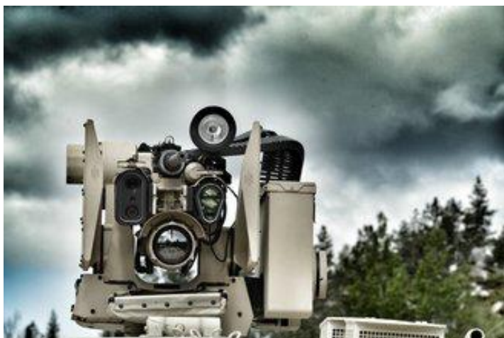
En RWS med våpen og en rekke forskjellige sensorsystemer montert på en norsk kampvogn. Foto: Kongsberg Protech Systems
