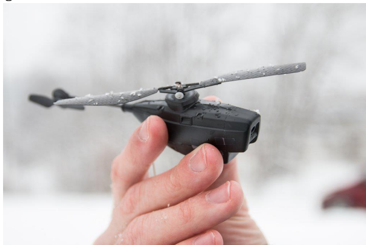
Black Hornet fra Flir, tidligere Prox Dynamics, er bare 12 centimeter lang og har en vekt på 18 gram. Foto: TU.no
