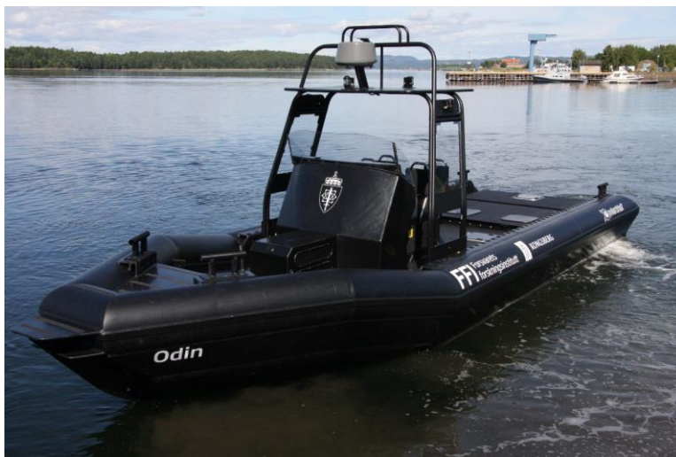
Odin, et ubemannet, autonomt overflatefartøy. Foto: TU.no, Tore Stensvold
