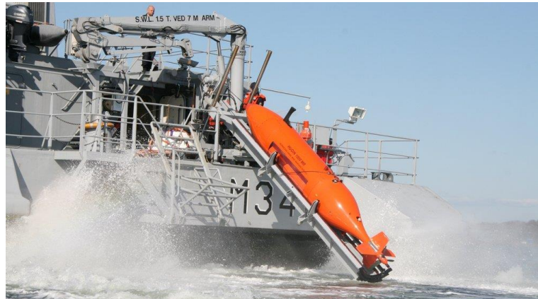
Hugin sjøsettes fra en av forsvarets minesveipere. Foto: Forsvaret
