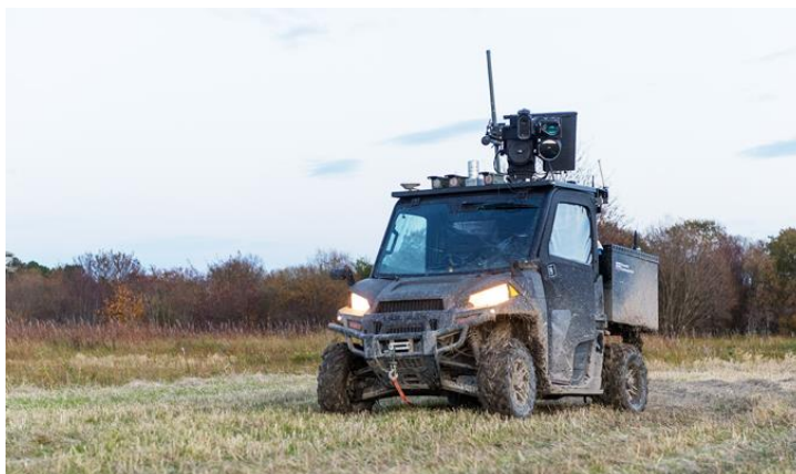
Olav, FFIs utviklingsplattform for autonome, landbaserte kjøretøy.
