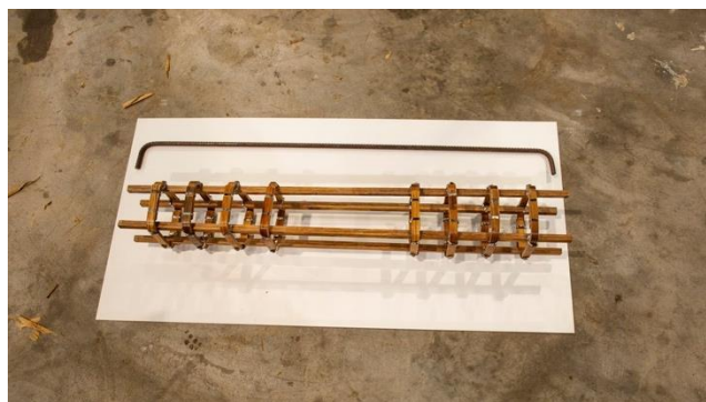
Forskere i Singapore har utviklet en kompositt av bambus som kan erstatte stålarmering i betong. Foto: Tuva Strøm Johannessen
