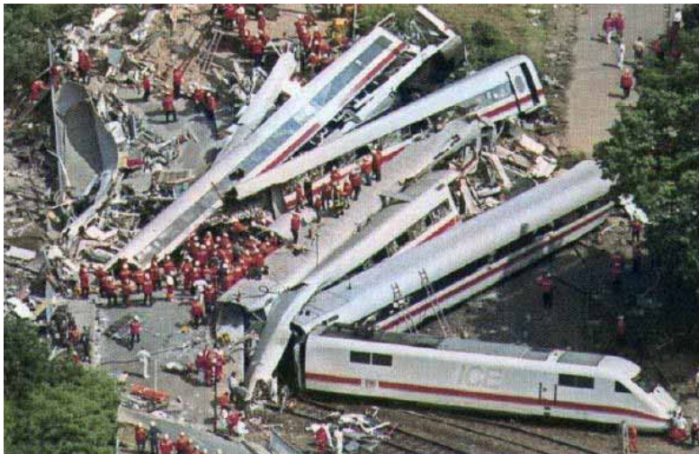
Avsporing av høyhastighetstog i Eschede. Årsaken var materialfeil i ett av hjulene
