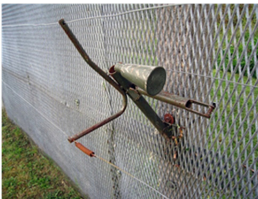
Selvskudds granat med utløser-mekanisme. Det var montert 60.000 av disse langs grensene
