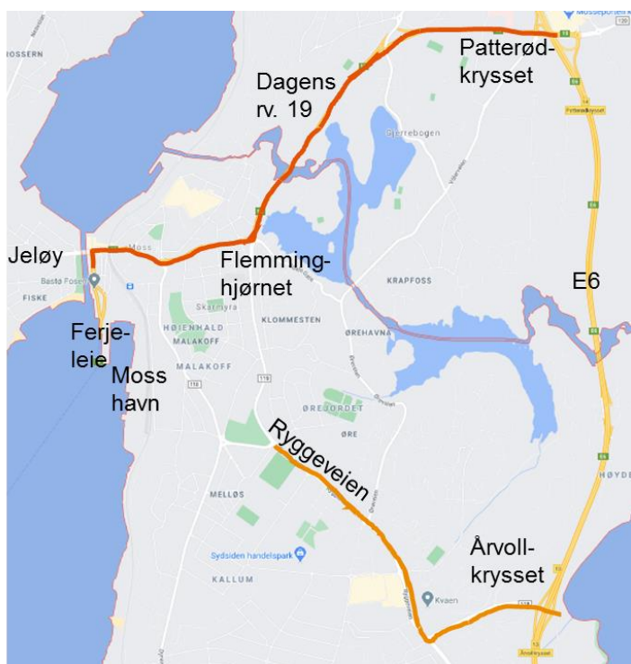
Figur 1.1 Området mellom ferjeleiet i Moss og E6. Riksveg 19 er markert med rød linje øverst i bildet, hele strekningen har kjente kapasitetsproblemer i dag. Nederst i bildet er vegstrekning som også har kjente kapasitetsproblemer i dag markert med oransje linje.
