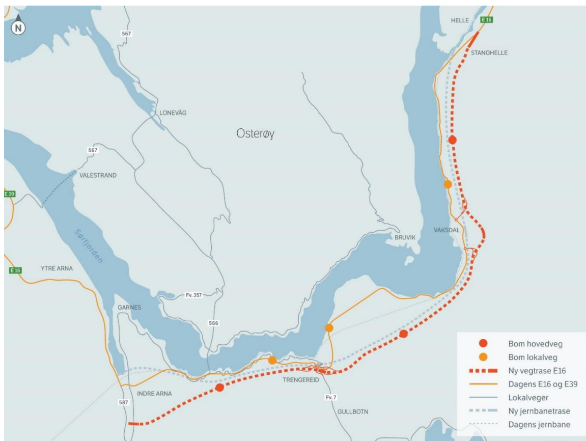
Figur 9-2 Plassering av bomstasjoner. Illustrasjon: Statens vegvesen
