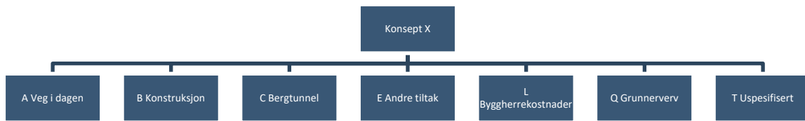
Figur 7-1: Overordnet PNS for usikkerhetsanalysen. Strukturen er representativ for samtlige konsepter
