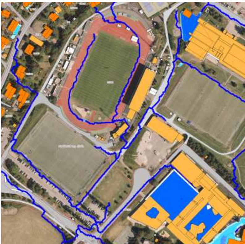
Bildet til venstre viser vannveier ved skybrudd på Nadderud.
