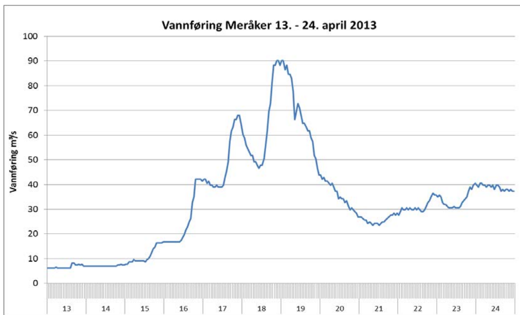
Figur 3.19. Vannføring (m 3 /s, timeverdier) ved målestasjon Meråker i perioden 13.-24.april 2013 (Data fra NVE/NTE).
