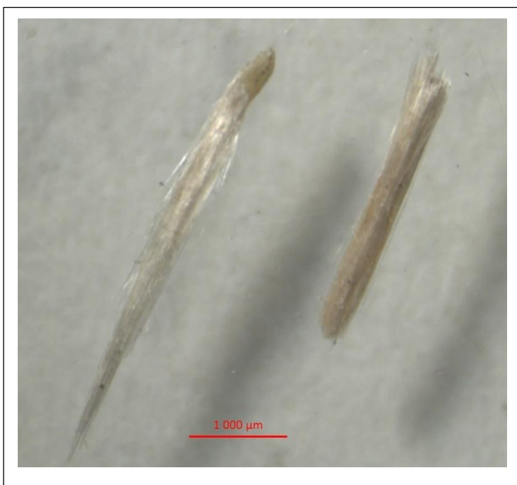
Figur 5. Asbestfibre fra husstrukturen i område 1. Foto: Lene S. Halvorsen.
