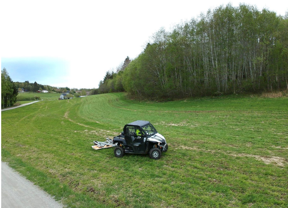
Figur 1: Georadarsystemet trukket bak NTNU Vitenskapsmuseets UTV. Foto: Arne Anderson Stamnes, NTNU VM
