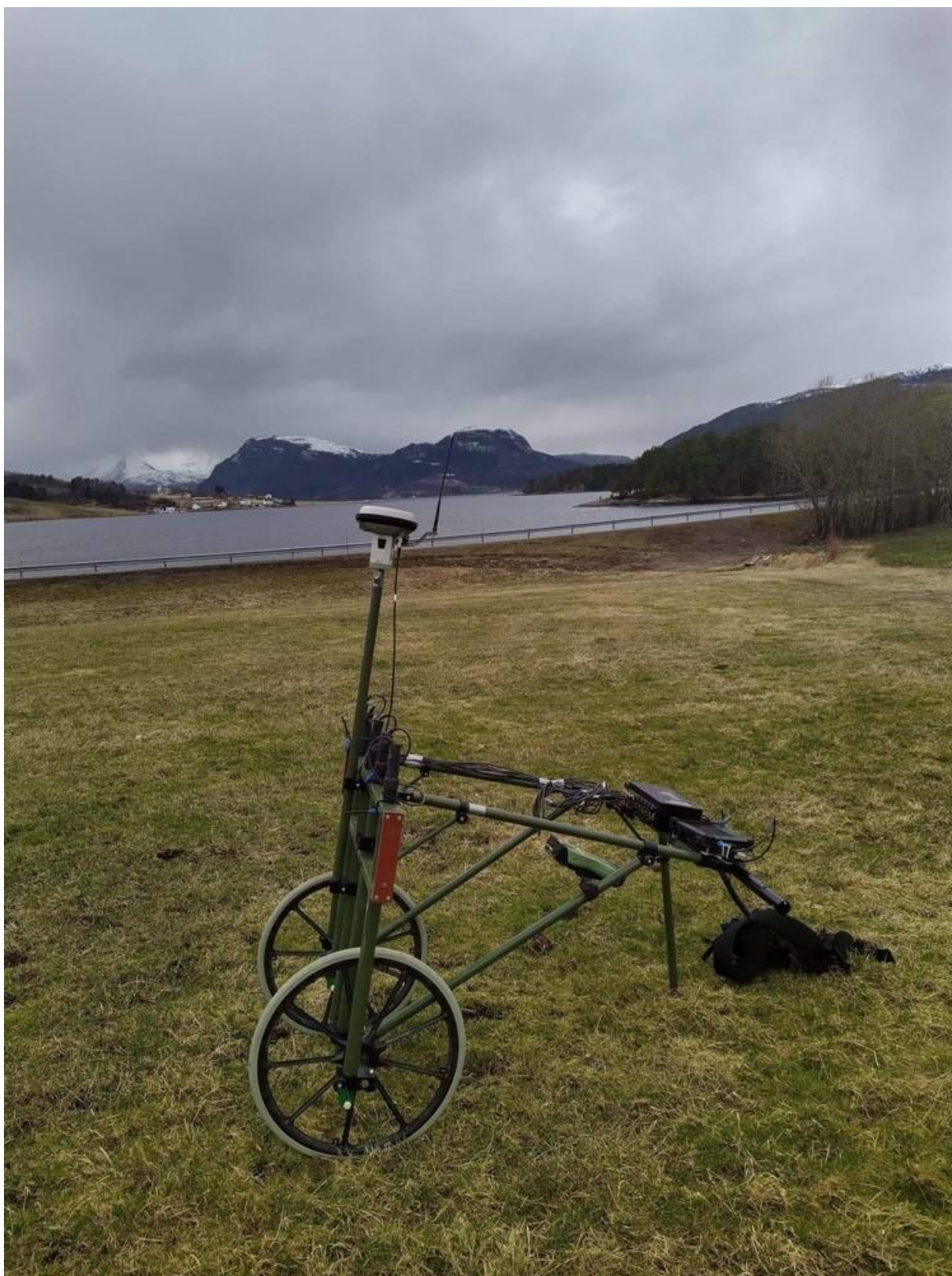
Figur 7: Sensys magnetometersystem konfigurert for manuelle målinger med 5 sensorer. Foto: Krzysztof Kiersnowski, NTNU Vitenskapsmuseet
