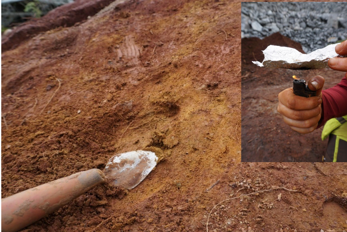
Figur 16. Urøstet malm (guloransje) hvor graveskje peker. Deler av innhold i den ene vollen ved ovnen. Da64275_079. Innfelt: Testing for påvisning av malm i felt. Urøstet malm blir magnetisk når den varmes opp (røstes). Da64275_080. Foto: Karen Ø. Oftedal, NTNU Vitenskapsmuseet
