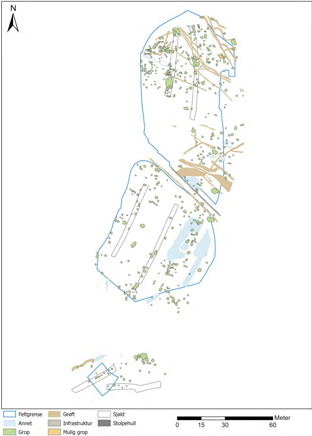
Figur 9: Eksempel på tolkninger av georadardataene fra Hestnes. Disse ble gjort tilgjengelig for utgravningsprosjektet forut for oppstart av selve flateavdekkingen.
