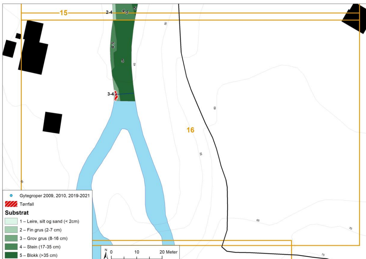
Figur 26. Gytegrøper fra 2009-2010 og 2019-2021, samt substrattyper og tørrlagte arealer. Driftsvannføring under bonitering av elva 10.-12. mai 2010 var på ca. 3 m 3 .
