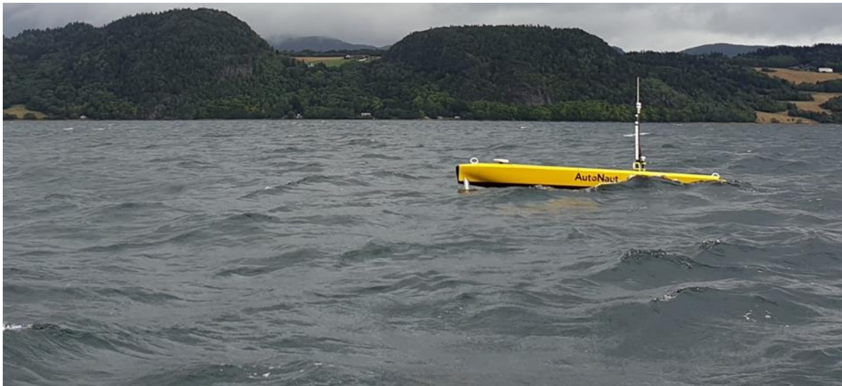
Figur 21. Den bølgedrevne autonome farkosten USV AutoNaut under uttesting i Gaulosen i september 2019. Farkosten er blant annet utstyrt med sensor for å søke etter og kartlegge bevegelser til akustisk merkede fisk. Foto Jo Arve Alfredsen.
