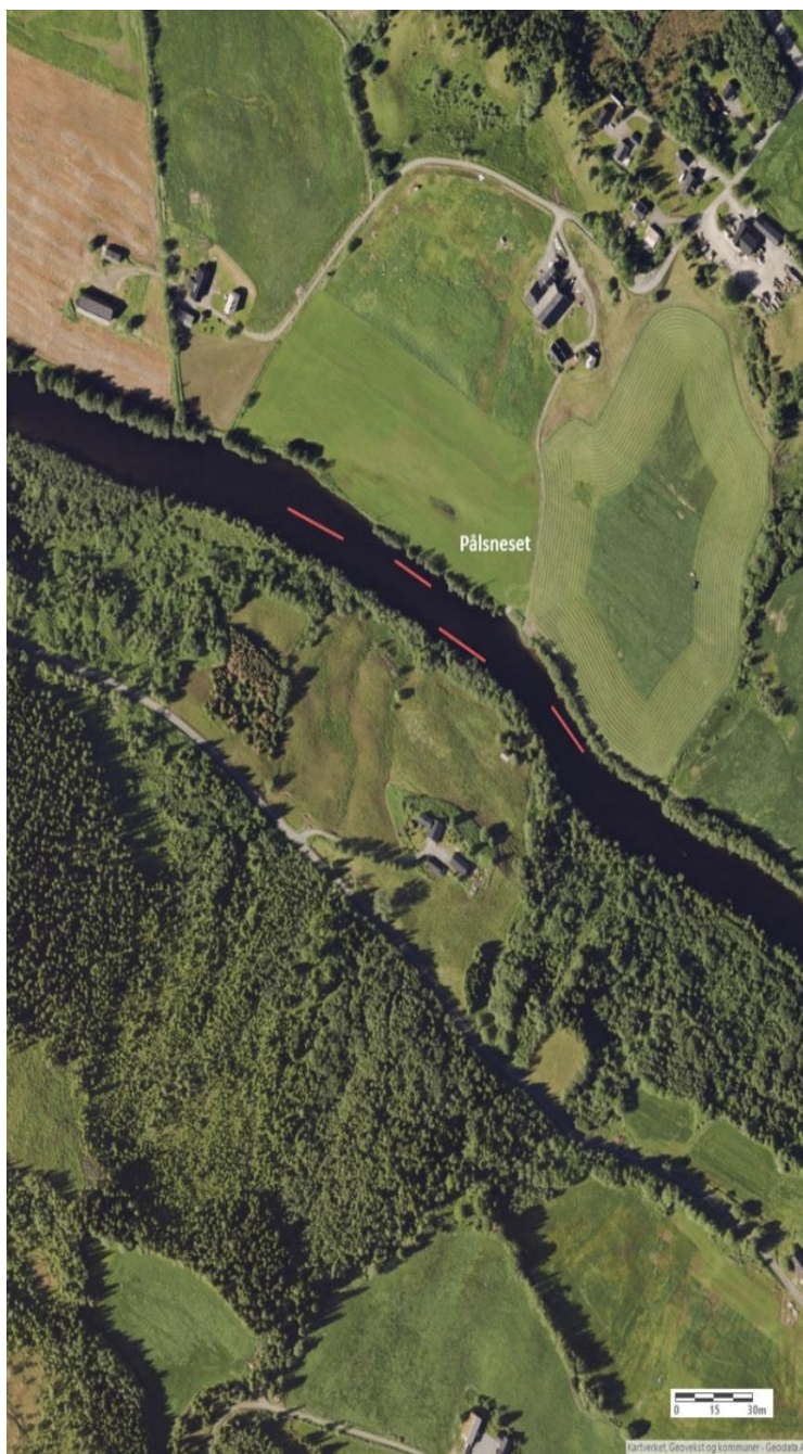
Figur 41. Ved Pålset i Stjørdalselva foreslår vi utsett av steinrygger som vil øke skjultilgang og lokalt bedre de hydrologiske forholdene for eldre fisk over et område på 12000 m 2 .
