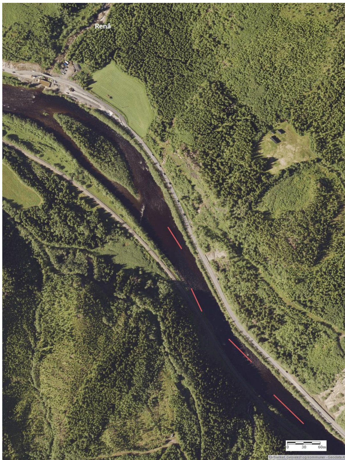
Figur 43. Oppstrøms Renå i Stjørdalselva foreslår vi utsett av steinrygger som vil øke skjultilgang og lokalt bedre de hydrologiske forholdene for eldre fisk over et område på 22000 m 2 .
