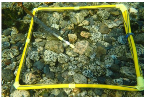
Figur 6. Illustrasjon av skjulmåling i bunnsubstratet. Foto: Jo Vegar Arnekleiv
