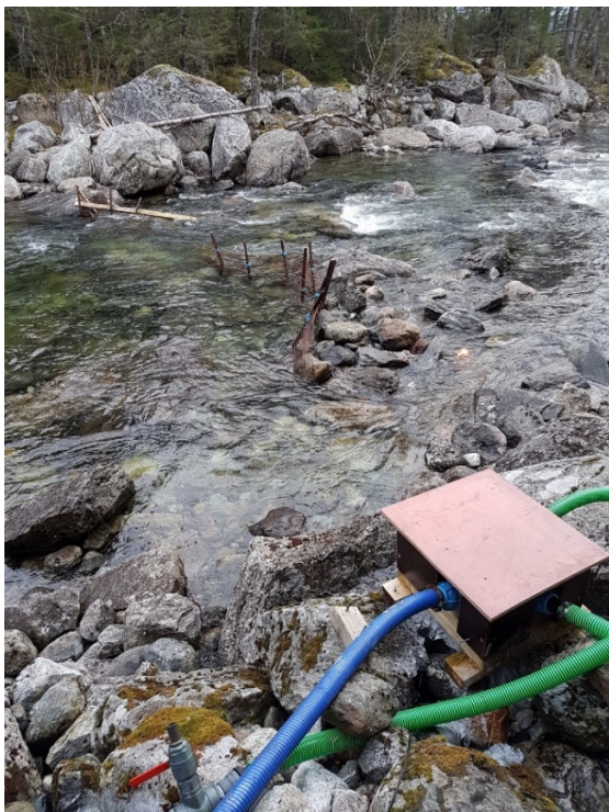
Figur 7. Tverrsnittet av utløpselva fra Urvoldvassdraget med ledegjerder. Fire overvåkningskameraer var plassert på bunnen i de to «vandingsrutene» som dannes av ledegjerdene. I forgrunnen er turbinen, som sørger for strømforsyning til videosystemet. Foto: Anders Lamberg.
