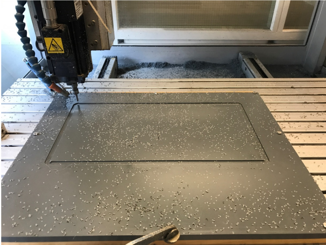
Figur 11 Her foregår utfresing av rammekant og tilvirking av emnet. Emnet er av hard PVC. Foto: Glenn Angell, Institutt for Teknisk kybernetikk, NTNU
