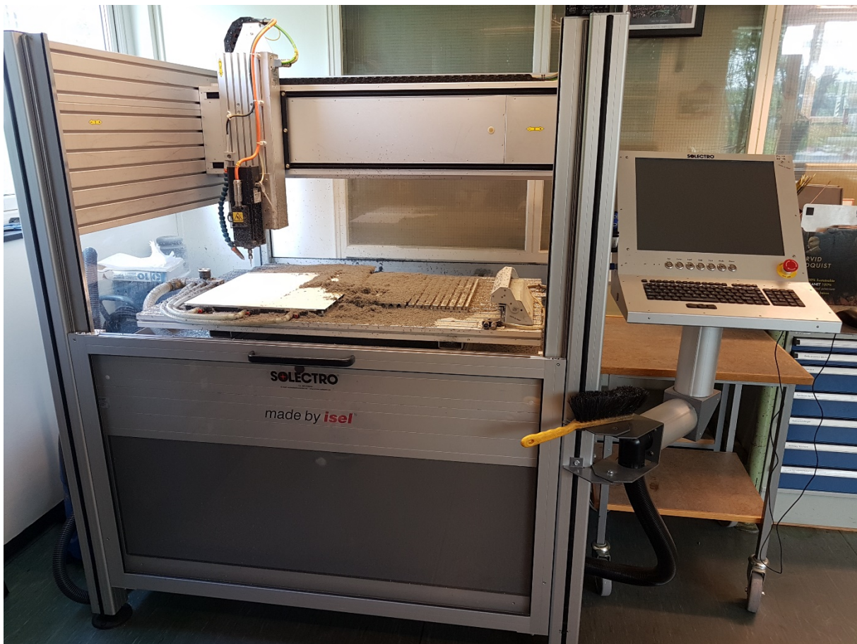
Figur 10 Maskinen som ble brukt til å frese ut 3D-modellen ved Institutt for teknisk kybernetikk ved NTNU. Foto: Lene Vestrum Kirkhus, NTNU Vitenskapsmuseet
