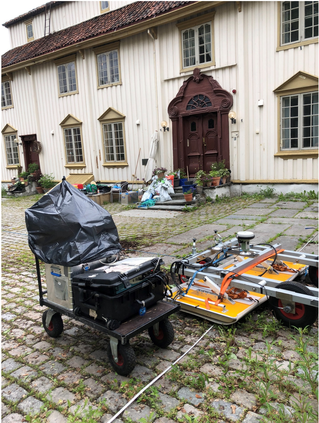
Figur 3: Feltbilde fra undersøkelsen på Bakke. Anetennesystemet er koblet under en modifisert tralle, og i dette tilfellet dyttet manuelt over undersøkelsesområdet innenfor et utplassert rutenett. Foto: Arne Anderson Stamnes, NTNU Vitenskapsmuseet
