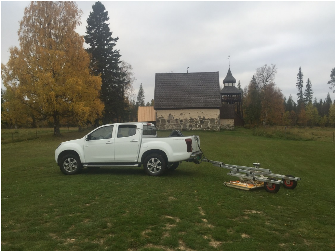
Figur 2: Datainnsamling over området foran Kyrkås gamla kyrka med NTNU Vitenskapsmuseets georadarsystem produsert av 3D-radar AS.
