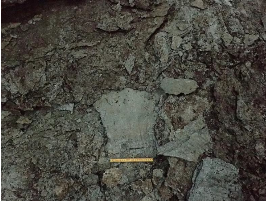
Figur 8: Detaljbilde av Fyllitt/Leirglimmerskifer. Løst berg kalles fløssberg. Da61128_026. Foto Synne Husby Rostad, NTNU Vitenskapsmuseet.
