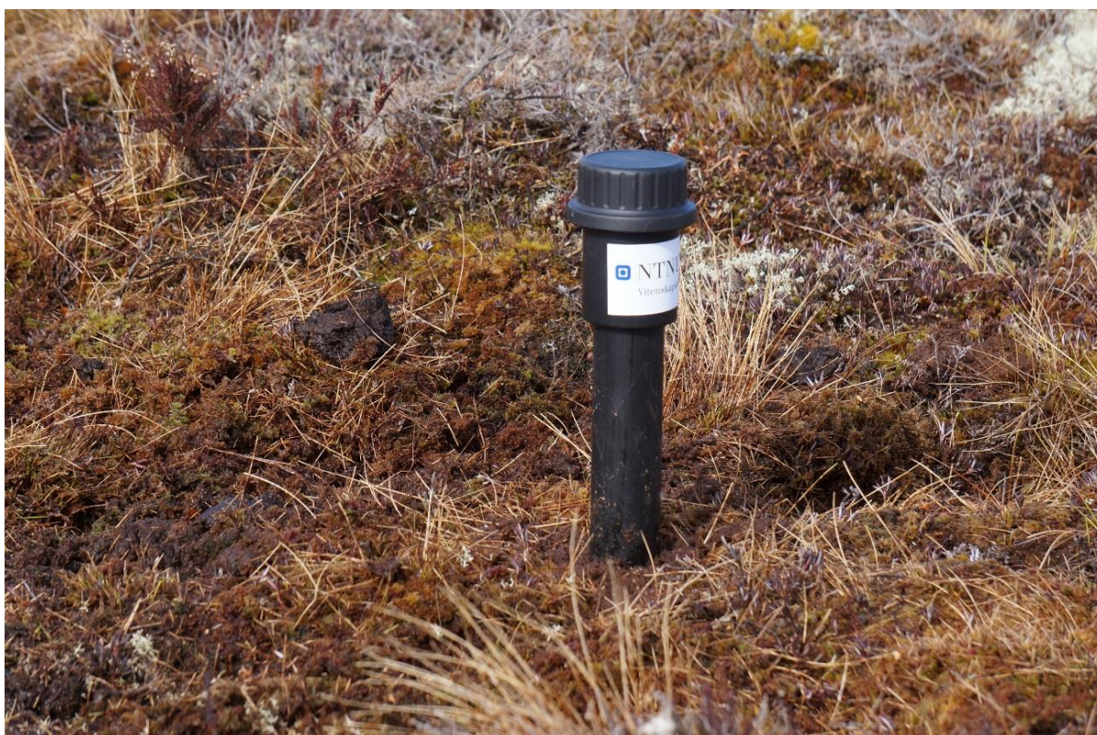
Figur 6. Foto av en av grunnvassbrønnene etter installasjon. M. Fandrem 28.4. 2017.
