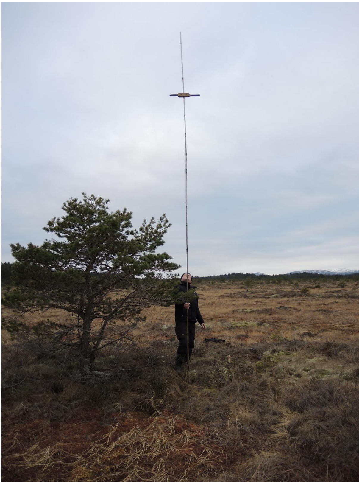
Figur 12. Måling av torvdybde på Høstadmyra, handtaket på torvboret markerer dybden. A. Lyngstad 14.2. 2017.
