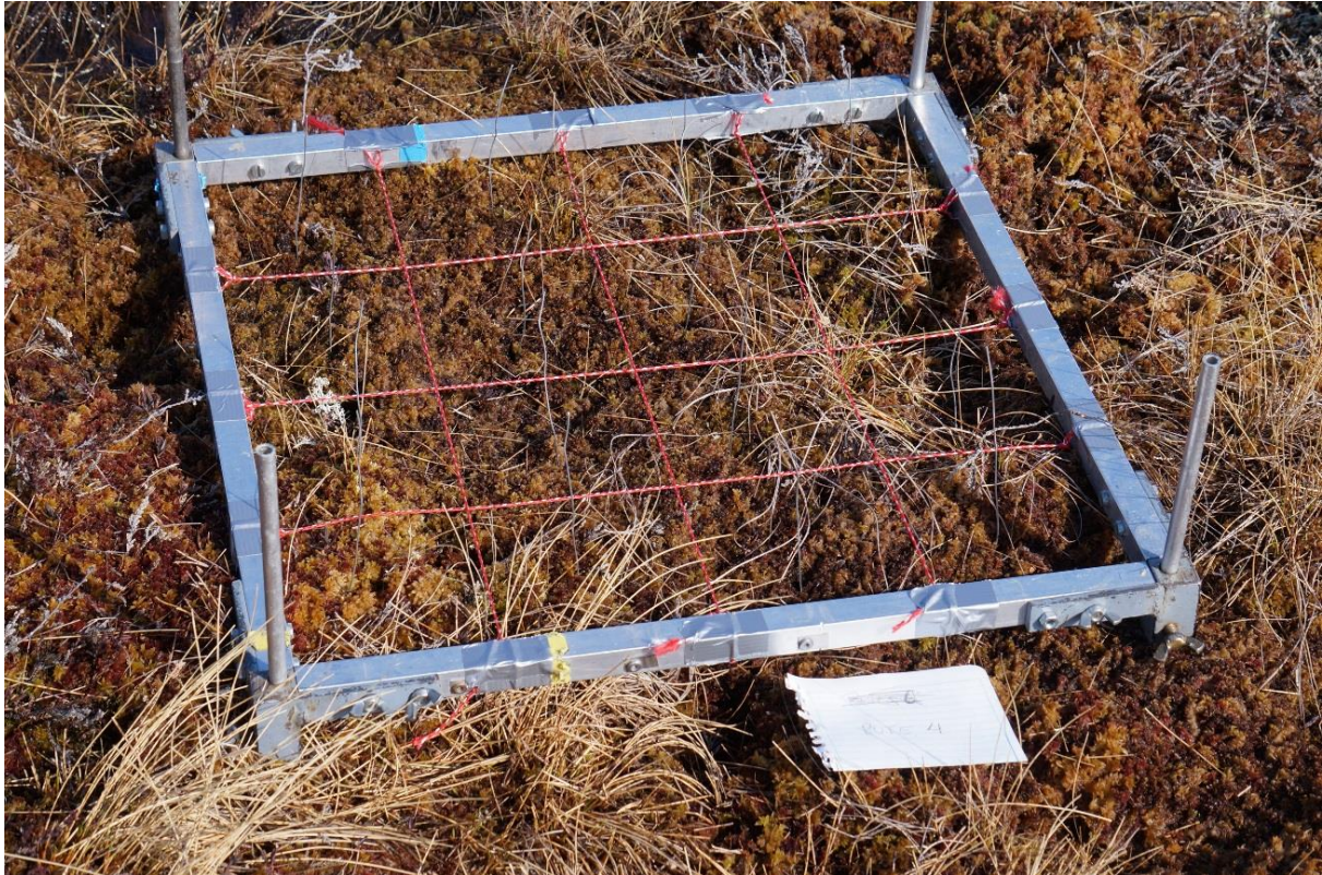
Figur 8. Rute (0,25 m 2 ) med ståltråder for måling av torvmosevekst. I hver av de mindre rutene oppmålt med rød tråd er det ett målepunkt. Ramma fjernes etter måling, så kun de små ståltrådene står igjen. M. Fandrem 3.5. 2017.
