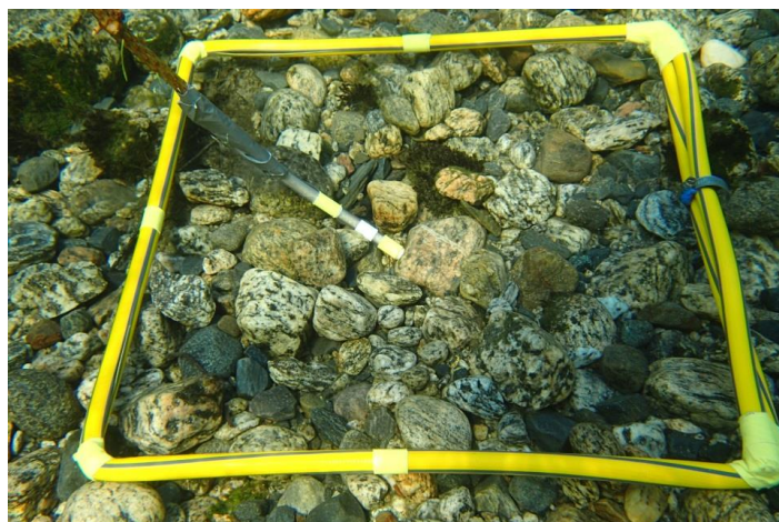
Figur 2. Måling av hulrom (skjul) i bunnssubstratet. Foto: Jo Vegar Arnekleiv
