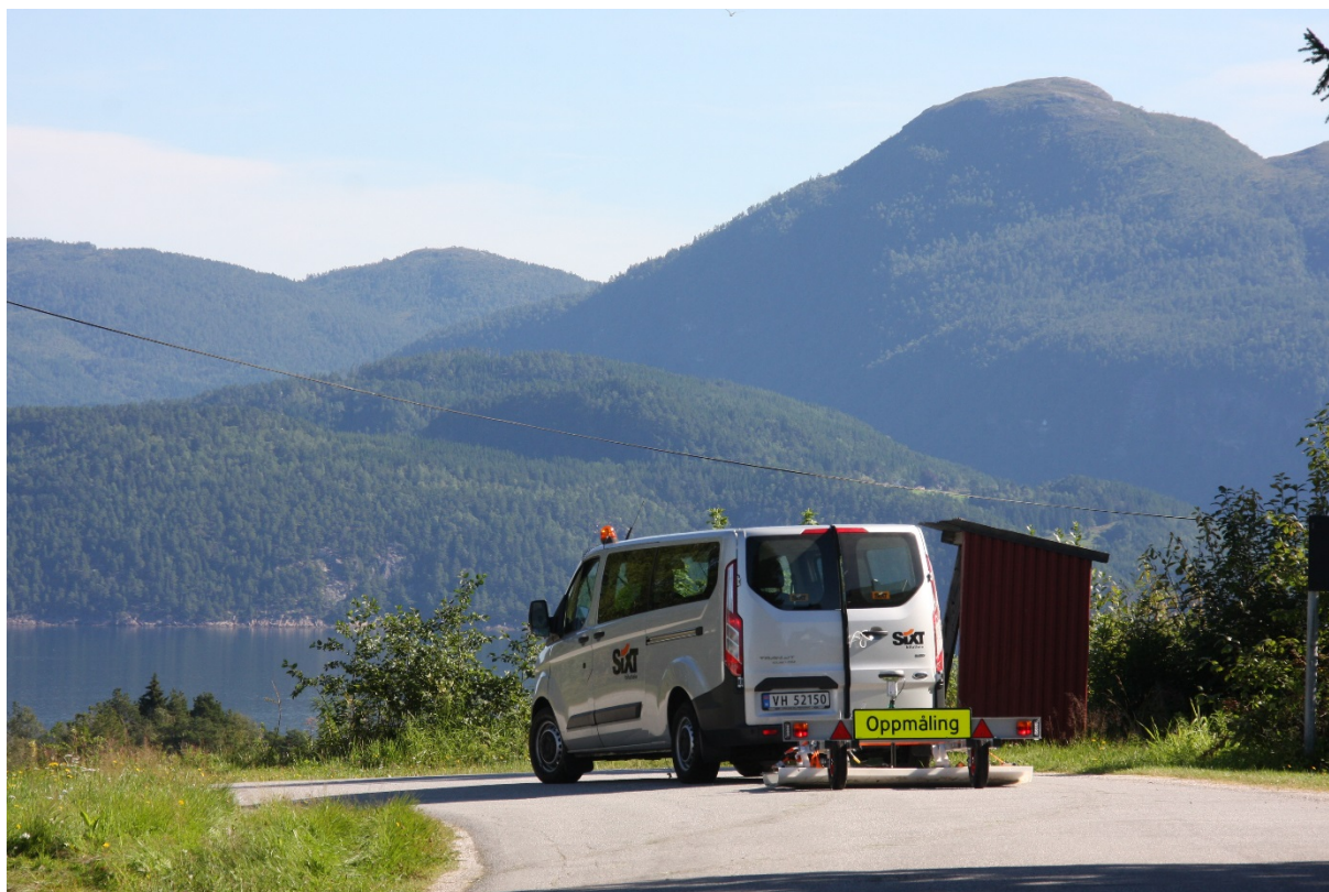
Figur 5: Datainnsamling i praksis med 3d-radar GPR. Foto: Arne Anderson Stamnes, NTNU Vitenskapsmuseet
