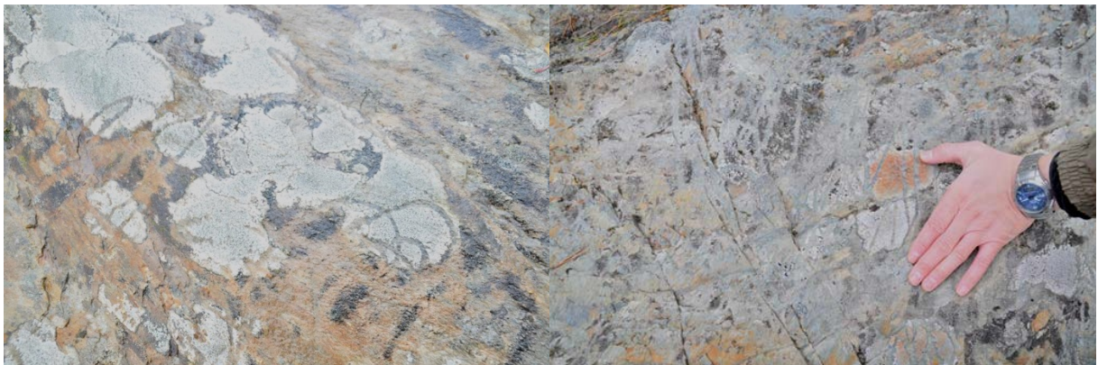
Fig. 6 og 7. Eksempel på trykkspyling som ikke bare har fjernet skorpelav, men også laget 5 mm brede linjer i berget. Ingen helleristninger hadde denne typen skader.
