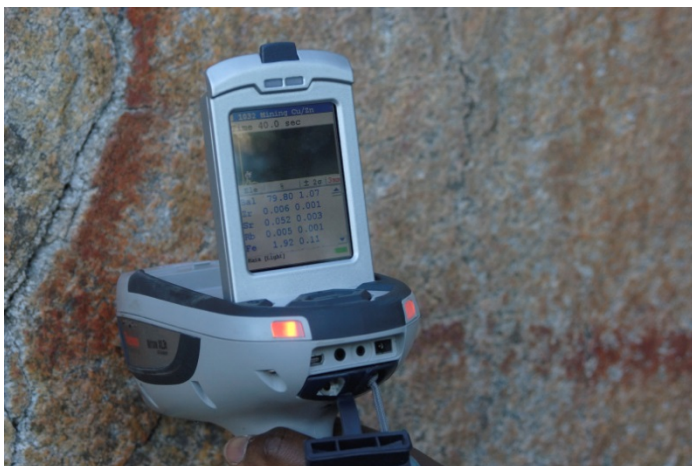
Figur 17. Håndholdt XR-F apparat i bruk på Honnhammer III. Foto: Daniela Pawel, NTNU Vitenskapsmuseet
