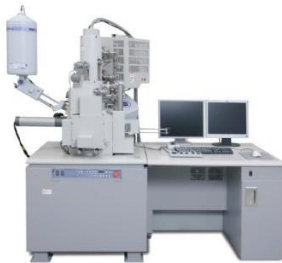
Figur 1 Hitachi SU6600 VP FE-SEM. Kilde: www.azonano.com
