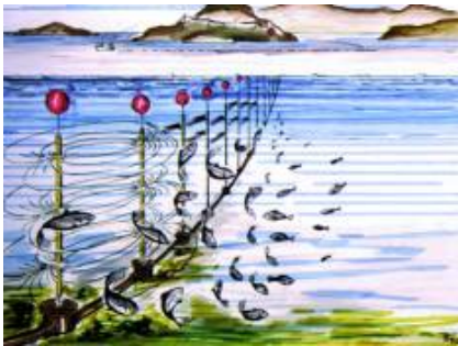
Figur 11: Et fiskestengsel som hindrer fisken i å vandre ut av et avgrenset område ved hjelp av kondisjonering. Lys- og lyd-signaler kombineres med elektriske støt fra lange vertikale elektroder i vannet.
