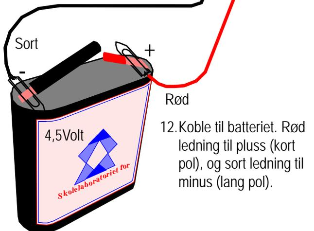
12. Koble til batteriet. Rød ledning til pluss (kort pol), og sort ledning til minus (lang pol).
