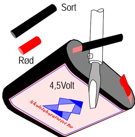
11. Skyv den sorte strømpa inn på den lange polen på batteriet, og den røde inn på den korte polen slik at det blir ca. 1 cm bart metall innest på hver side. Brett ut polene og varm opp med loddekolben, til plaststrømpa krymper omkring metallpolen.
