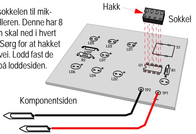
8. Monter de 7 lysdiodene. Pass på at den lange ledningen skal ned i hullet nærmest pluss-tegnet. Lodd fast beina på diodene på loddessiden. Klipp av beina.
