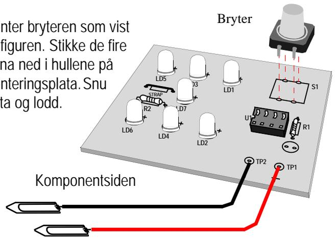
10. Trykk den sorte mikrokontrolleren ned i sokkelen. Påse at det vesle hakket er på rett side.
